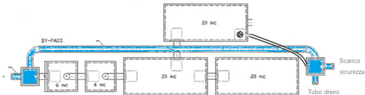
Fig. n. 8 – Schema scarico di sicurezza delle acque di seconda pioggia
